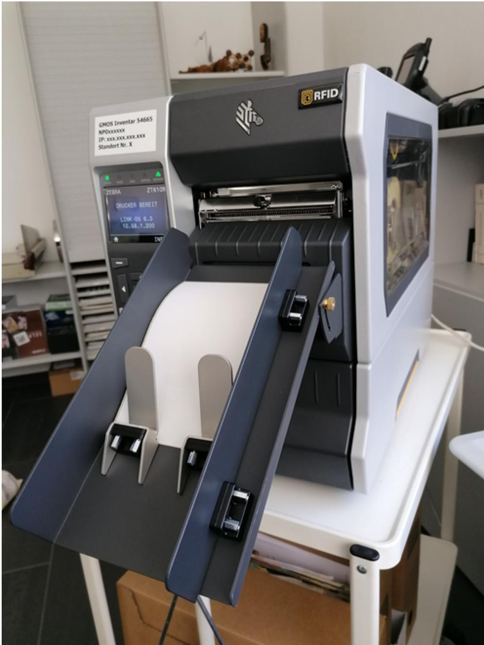
Verwendet werden leere Selbstklebe-Etiketten der Breite 101 mm und Länge 152 mm. Das Trägerband ist 106 mm Breit, und der Abstand zweier Etiketten beträgt 3.5 mm. 25 mm von der Vorderkante (in Druckrichtung) ist ein RFID Tag vom Typ «SMARTRAC DogBone» integriert:
