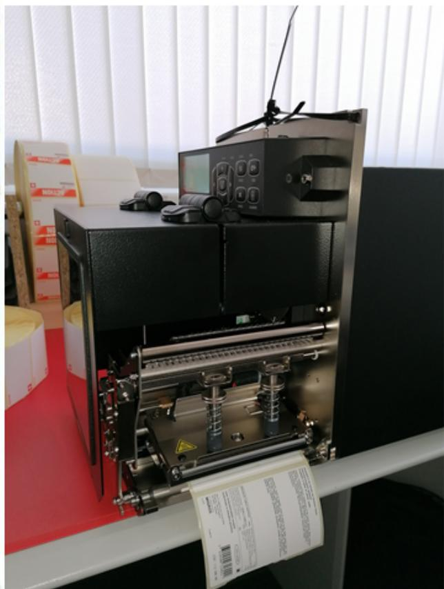
Gegenüber den beiden oberen Etiketten wird die untere Etikette um 90° gedreht gedruckt. Der ZPL Befehl ^PO kann dazu nicht verwendet werden da er nur normal oder um 180° gedreht unterstützt. Der Befehl ^PON wird aber als erstes gesendet um zunächst wieder die Normalrichtung einzustellen, falls vorher der invertierte Druck aktiv war.
